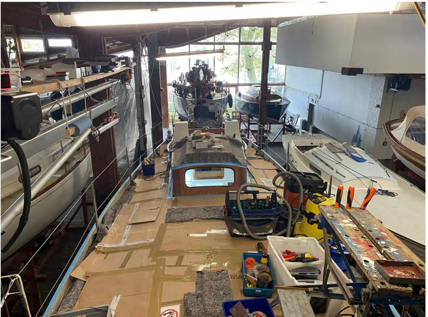
Gleich nachdem „Ratokker“ in der Halle steht, wird die Aussenhaut geschliffen, getönt und lackiert. Auch Cockpit und Aufbau wird die pflegende Hand zuteil.
