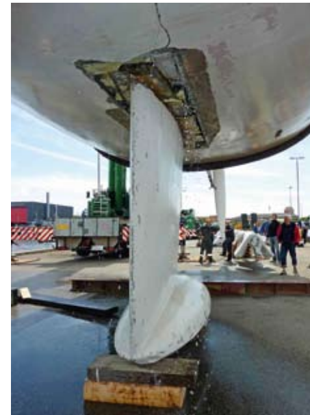
Der Grund für den Wassereintritt, Schäden im Kielbereich Beide Foto: ESV-Information 1/11
