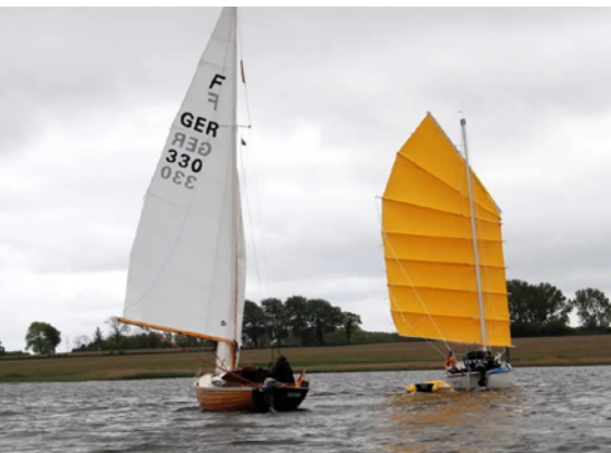
Geballte Power: Durch die Lattung fängt das Segel noch mehr Wind ein – das Segel kann nicht einfallen (Foto © Kristian Dittmann)
