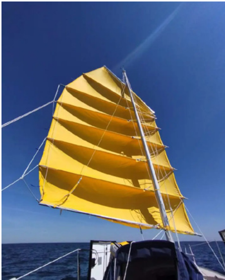
Eingenähtes Segelprofil zeichnet das moderne Dschunkenrigg aus
