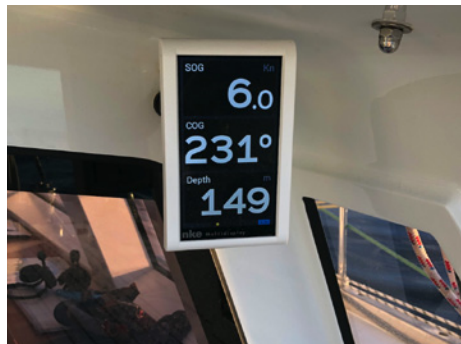
Bild 3: Die NKE-Anzeige zeigt zum gleichen Zeitpunkt wie die B&G-Anzeige oben SOG und in der Mitte COG. Der COG-Wert der GPS-Antenne des NKE-Systems wird im NMEA 0183-Topline-Bus mit einer Differenz von 14 Grad im Vergleich zum NMEA 2000-Bus angezeigt. Diese „Korrektur“ korrespondiert zur lokalen magnetischen Missweisung.
