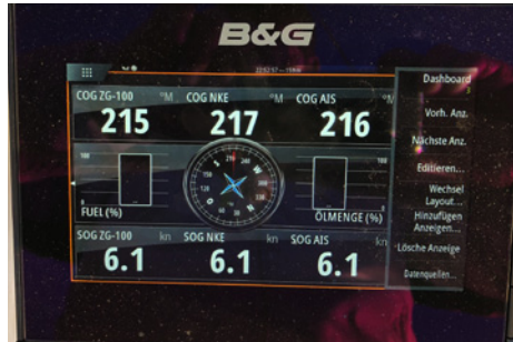
Bild 2: Unser B&G-Plotter mit simultaner Anzeige von COG und SOG unserer 3 Systeme im NMEA 2000-Bus. Die Werte für COG von B&G (links), NKE (Mitte)
