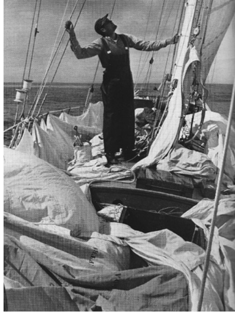
Regattasegeln in den Fünzigern: Makosegel müssen bei Leichtwetter getrocknet werden, schwere Beschläge, hölzerne Blöcke, geschlagenes Manilatauwerk, Stagreiter, Schamfilschutzrollen (Foto: aus dem besprochenen Buch)
