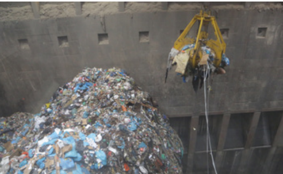
Der Polypgreifer im Müllbunker
