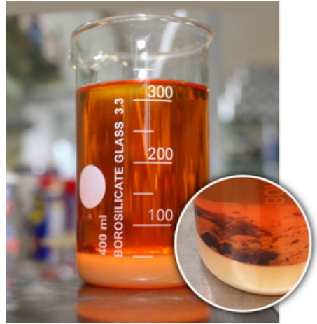
Dieselpest im Labor (Foto: Liqui Moly)
