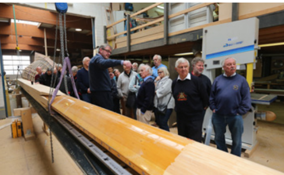
Der geschäftete Mast
